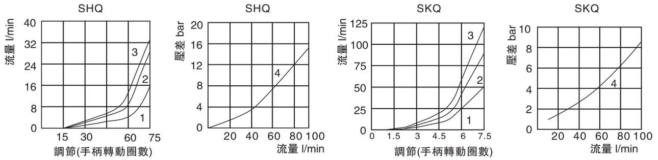
注：1=  $\Delta P$ 為10bar的調節曲綫； 2=  $\Delta P$ 為30bar的調節曲綫； 3=  $\Delta P$ 為50bar的調節曲綫； 4= 流經單向閥的Q/ $\Delta P$ 曲綫。
